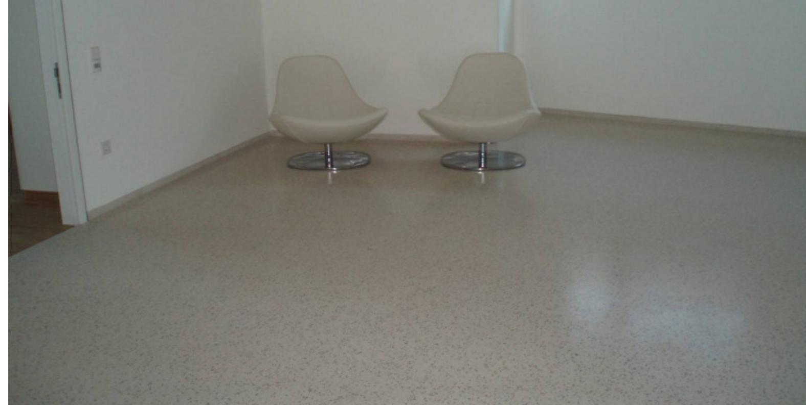
Terrazzo ist ein, bereits seit der Antike, bekannter Bodenbelag, der durch das direkte Auftragen von zementgebundenen Granulaten und im Anschluss an die Trocknung durch Schleifen und Polieren seine einzigartige und glänzende Oberfläche erhält.
